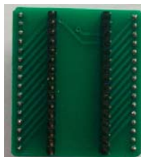
LQFP-32的转换座(反面)
